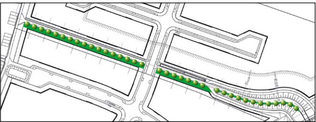
Fig. 46 : Structure guide pour les chauves-souris qui ombrage un chemin à Fribourg-en-Brisgau
